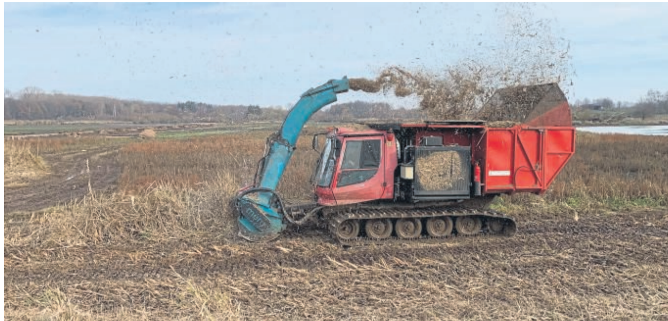
Der Teichmäher im Einsatz: Wie geplant wuchsen die Pflanzen auf dem Grund explosionsartig. Sie wurden gemäht und das Schnittgut aus dem See entfernt.
